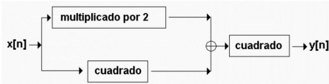
Figura 8.1.4.- Señal de salida de una función en paralelo
