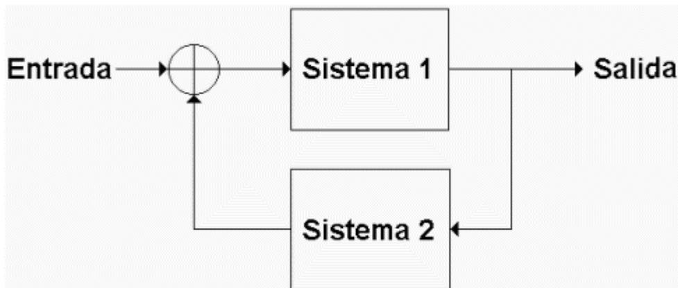
Figura 8.1.5.- Señal de salida en retroalimentación
